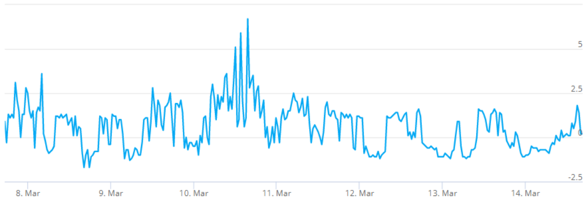
Kuva 8. Tutkimuspiste P7, Kirjasto, uusi osa. Sisäilman ja ulkoilman välinen paine-ero 7.3. – 14.3.2022, ka 0,59 Pa .
