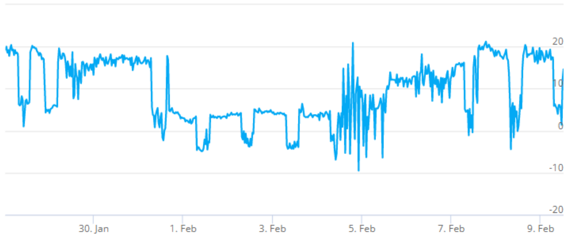
Kuva 31. Tutkimuspiste L8 (P5), kellarikerroksen ruokala 02. Sisäilman ja ulkoilman välinen paine-ero 28.1. - 9.2.2022.
