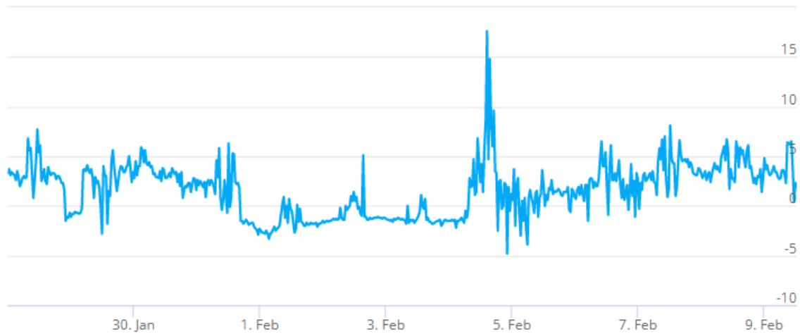
Kuva 17. Tutkimuspiste L5 (P2), 1. krs opettajien taukotila (115). Sisäilman ja ulkoilman välinen paine-ero 28.1. – 9.2.2022.
