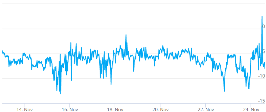
Kuva 38. Tutkimuspiste L10 (P3), kellarikerroksen puutyötila 023. Sisäilman ja ulkoilman välinen paine-ero 12.11.- 24.11.2021, ka - 6,3 Pa.
