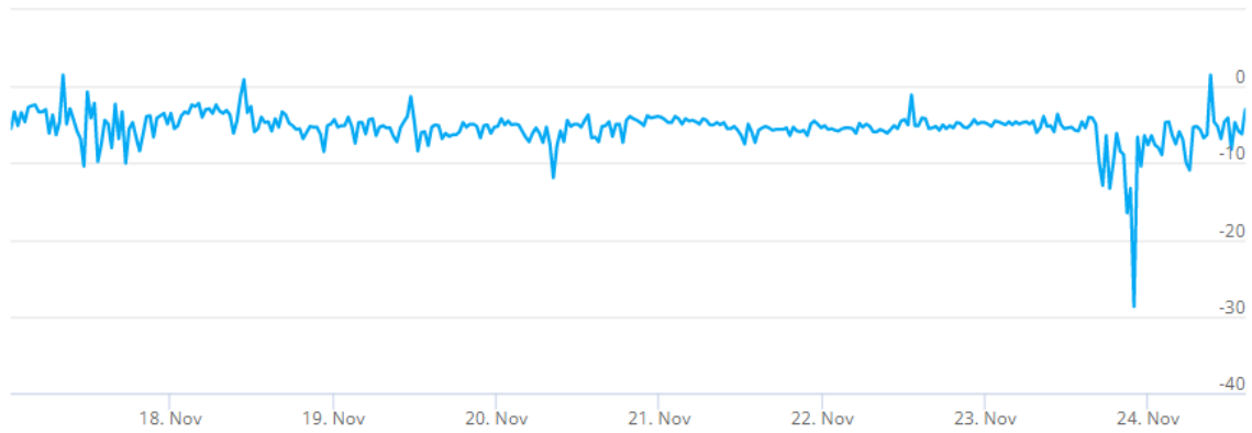
Kuva 11. Tutkimuspiste L5 (P2), 1. krs opettajien taukotila (115). Sisäilman ja ulkoilman välinen paine-ero 17.11. – 24.11.2021, ka – 5,4 Pa.
