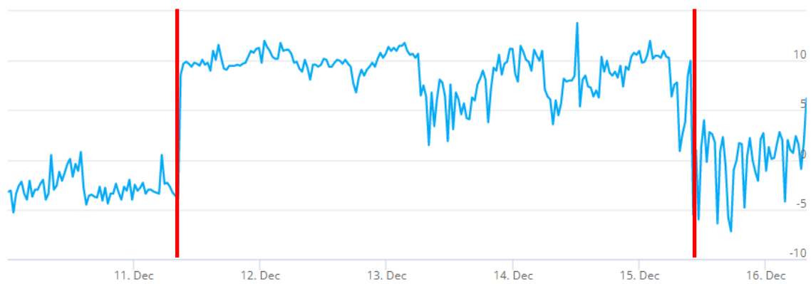
Kuva 14. Tutkimuspiste L5 (P2), 1. krs opettajien taukotila (115). Sisäilman ja ulkoilman välinen paine-ero 10.12. – 16.12.2021.
