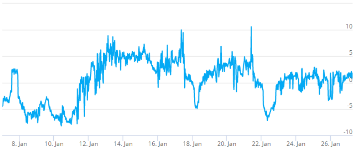
Kuva 42. Tutkimuspiste L10 (P3), kellarikerroksen puutyötila 023. Sisäilman ja ulkoilman välinen paine-ero 7.1.-27.1.2022.
