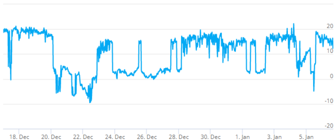
Kuva 29. Tutkimuspiste L8 (P5), kellarikerroksen ruokala 02. Sisäilman ja ulkoilman välinen paine-ero 17.12. - 6.1.2022.
