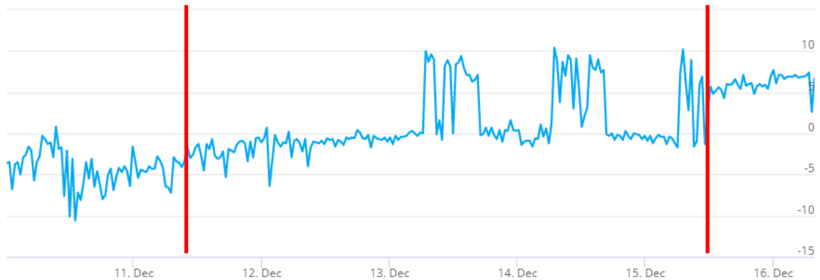
Kuva 34. Tutkimuspiste L9 (P8), 1. krs Sali 121. Sisäilman ja ulkoilman välinen paine-ero 10.12.- 16.12.2021.
