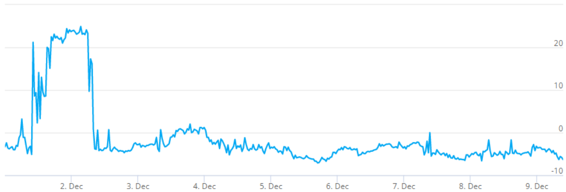
Kuva 21. Tutkimuspiste L7 (P4), 1. krs luokkatila 104 (Luokka 2.). Sisäilman ja ulkoilman välinen paine-ero 1.12.-9.12.2021, ka -1,2 Pa.
