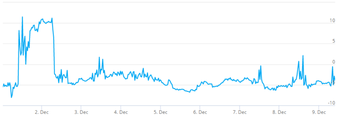
Kuva 13. Tutkimuspiste L5 (P2), 1. krs opettajien taukotila (115). Sisäilman ja ulkoilman välinen paine-ero 1.12. – 9.12.2021, ka – 2,7 Pa.
