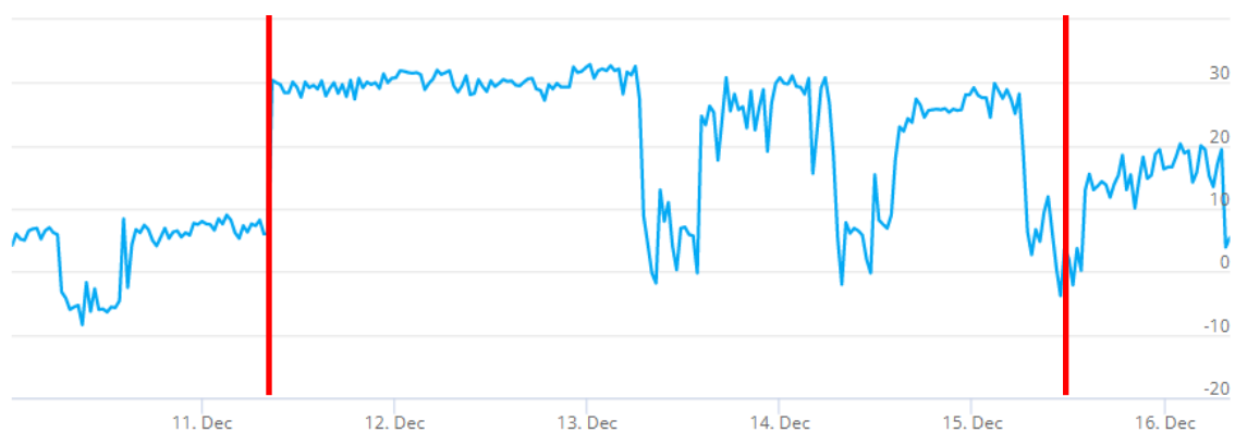
Kuva 28. Tutkimuspiste L8 (P5), kellarikerroksen ruokala 02. Sisäilman ja ulkoilman välinen paine-ero 10.12. - 16.12.2021.
