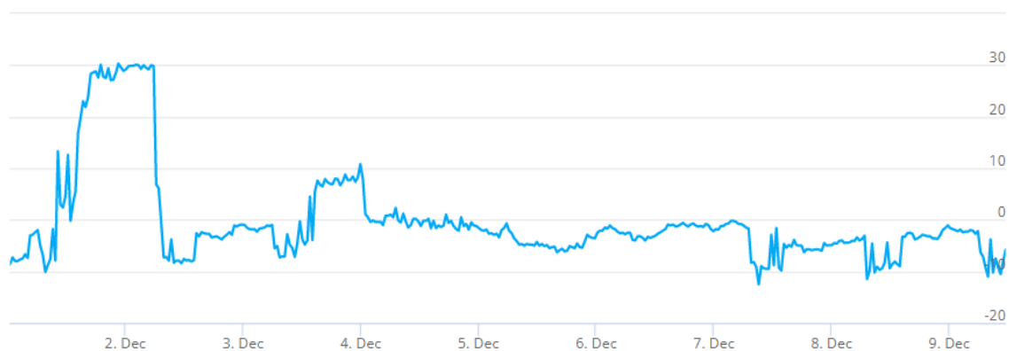
Kuva 27. Tutkimuspiste L8 (P5), kellarikerroksen ruokala 02. Sisäilman ja ulkoilman välinen paine-ero 1.12. - 9.12.2021, ka - 0,03 Pa.
