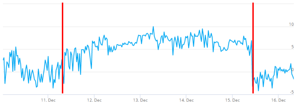
Kuva 40. Tutkimuspiste L10 (P3), kellarikerroksen puutyötila 023. Sisäilman ja ulkoilman välinen paine-ero 10.12.-16.12.2021.
