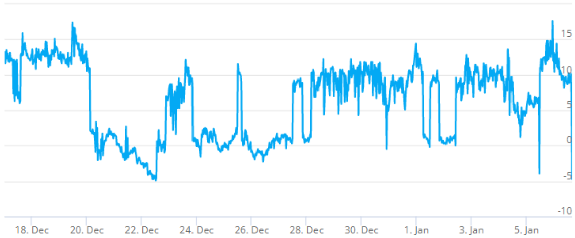
Kuva 23. Tutkimuspiste L7 (P4), 1. krs luokkatila 104 (Luokka 2.). Sisäilman ja ulkoilman välinen paine-ero 17.12.-6.1.2022.
