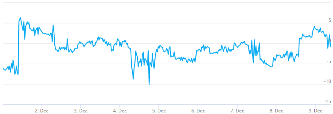
Kuva 39. Tutkimuspiste L10 (P3), kellarikerroksen puutyötila 023. Sisäilman ja ulkoilman välinen paine-ero 1.12.-9.12.2021, ka - 0,1 Pa.
