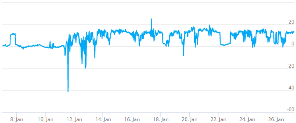
Kuva 9. Tutkimuspiste L4 (P1), 1. krs luokkatila 105 (Luokka 1). Sisäilman ja ulkoilman välinen paine-ero 7.1. – 27.1.2022.
