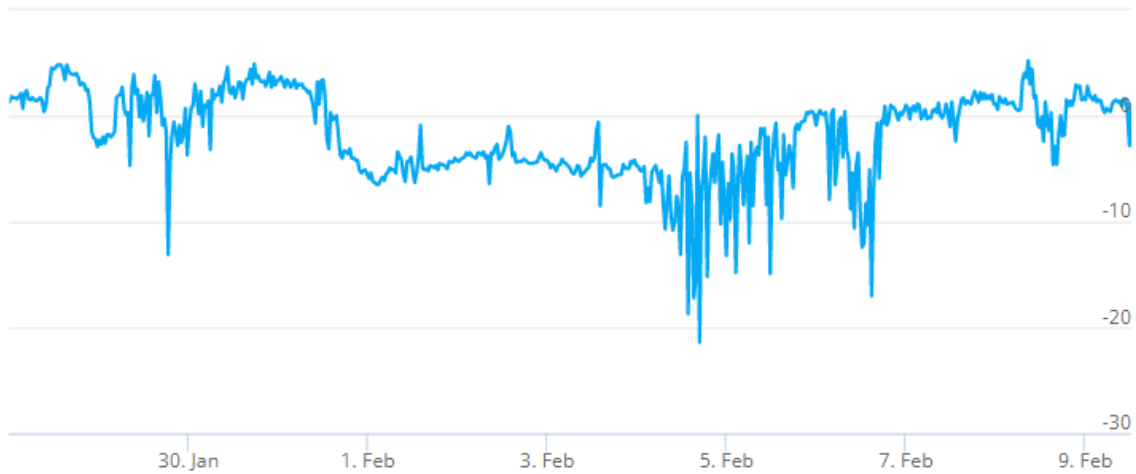
Kuva 43. Tutkimuspiste L10 (P3), kellarikerroksen puutyötila 023. Sisäilman ja ulkoilman välinen paine-ero 28.1.-9.2.2022.
