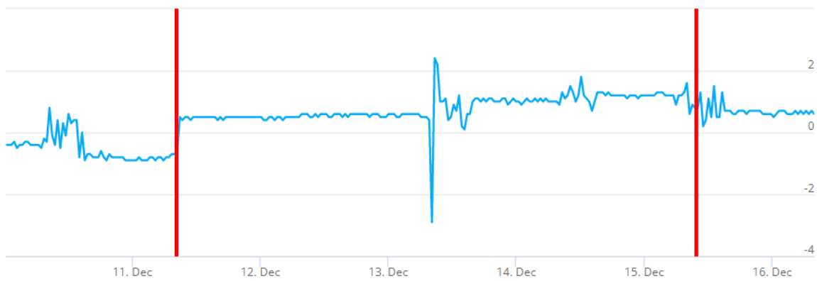
Kuva 46. Tutkimuspiste L11 (P11), 1. krs opettajien taukotilan 115 ja esikoulun pientilan 070 välinen paine-ero 10.12. – 16.12.2021.
