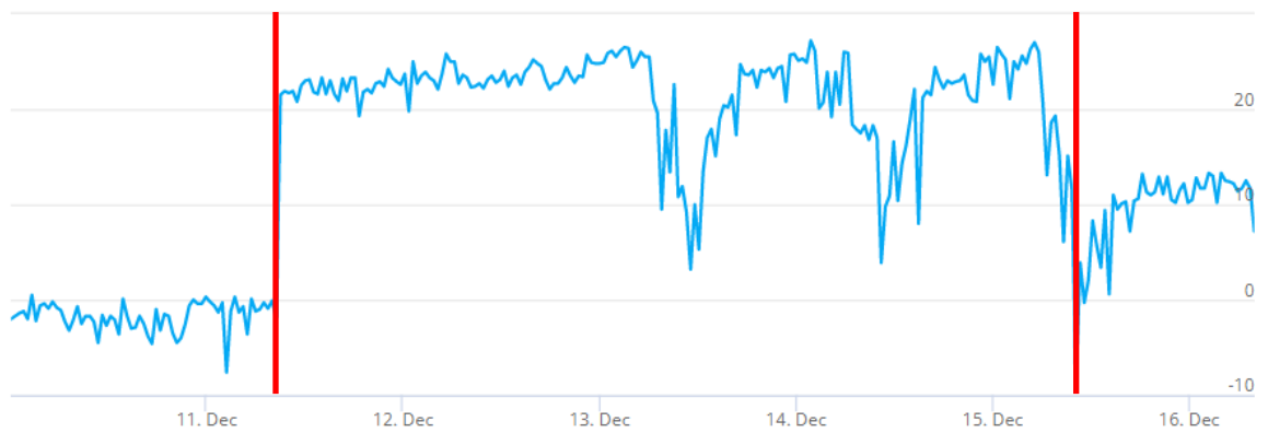
Kuva 22. Tutkimuspiste L7 (P4), 1. krs luokkatila 104 (Luokka 2.). Sisäilman ja ulkoilman välinen paine-ero 10.12.-16.12.2021.
