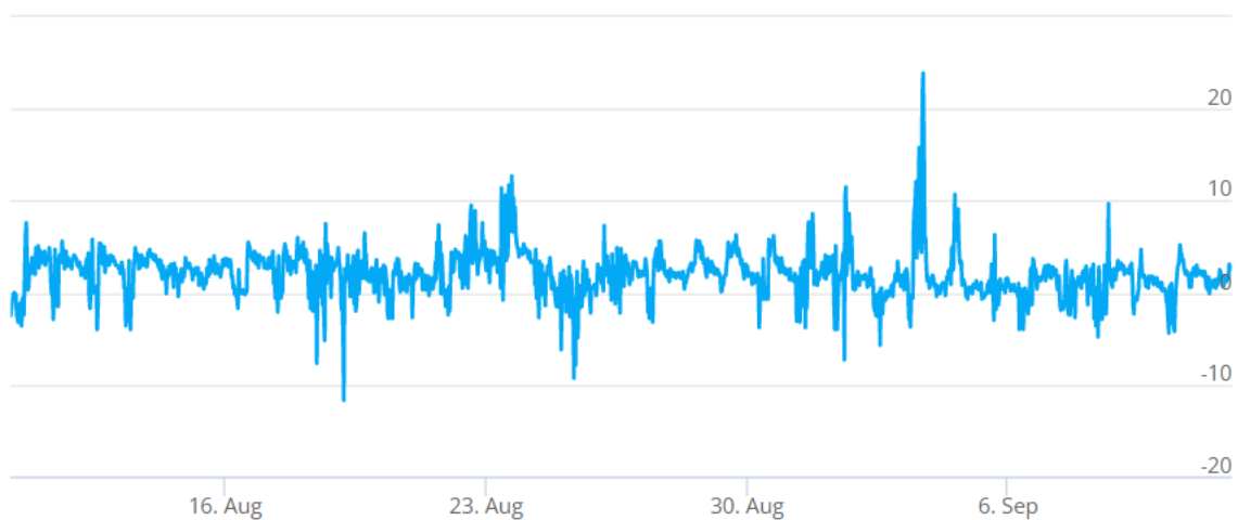
Kuva 18. Tutkimuspiste L6 (P3), 1. krs luokkatila 103 (Luokka3.). Sisäilman ja ulkoilman välinen paine-ero 10.8.-12.9.2021, ka 2,0 Pa.
