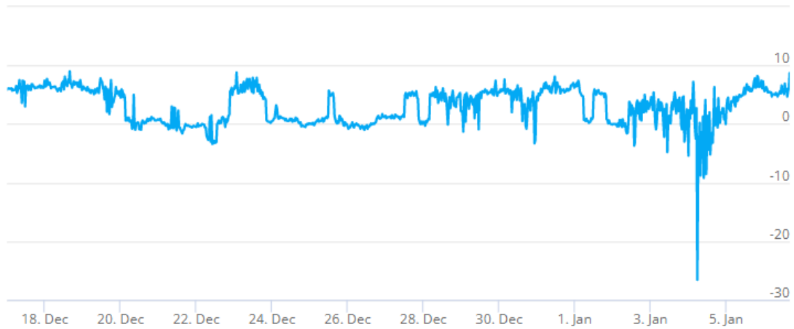
Kuva 35. Tutkimuspiste L9 (P8), 1. krs Sali 121. Sisäilman ja ulkoilman välinen paine-ero 17.12.- 6.1.2022.
