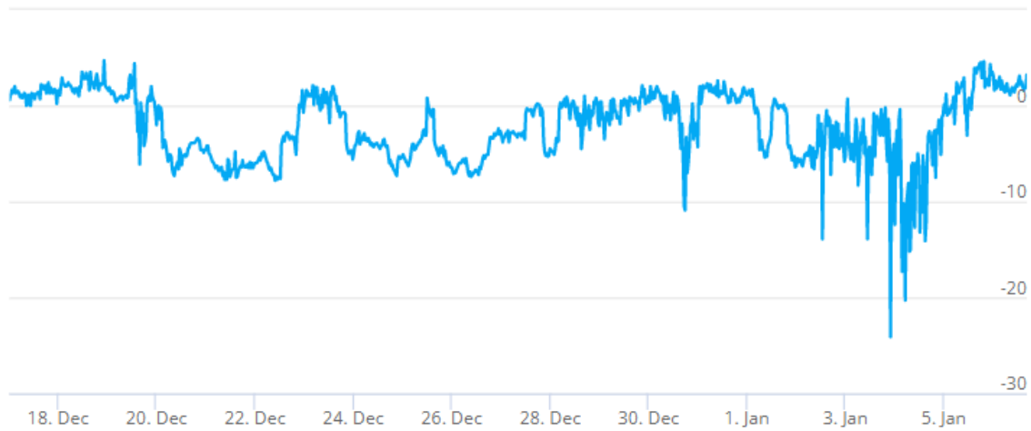
Kuva 41. Tutkimuspiste L10 (P3), kellarikerroksen puutyötila 023. Sisäilman ja ulkoilman välinen paine-ero 17.12.-6.1.2022.
