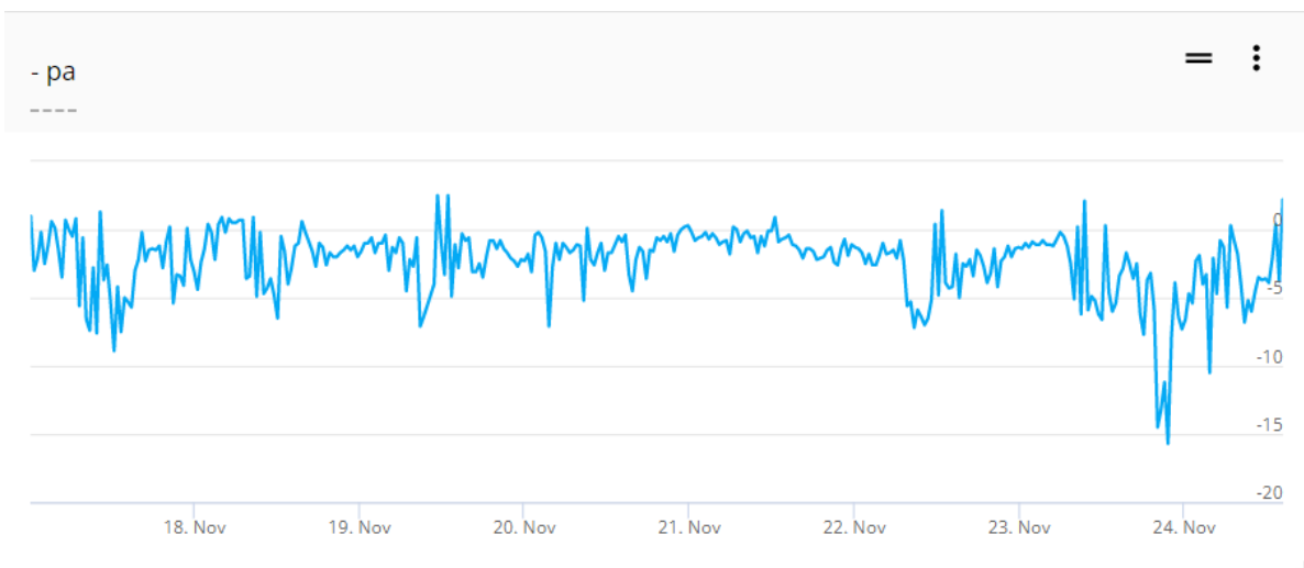
Kuva 4. Tutkimuspiste L4 (P1), 1. krs luokkatila 105 (Luokka 1). Sisäilman ja ulkoilman välinen paine-ero 17.11. – 25.11.2021, ka -2,4 Pa .
