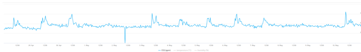
Kuva 109. Tutkimuspiste L2, 1. kerroksen pienopetustila 110. Sisäilman hiilidioksidipitoisuus 28.4. – 11.5.2021.
