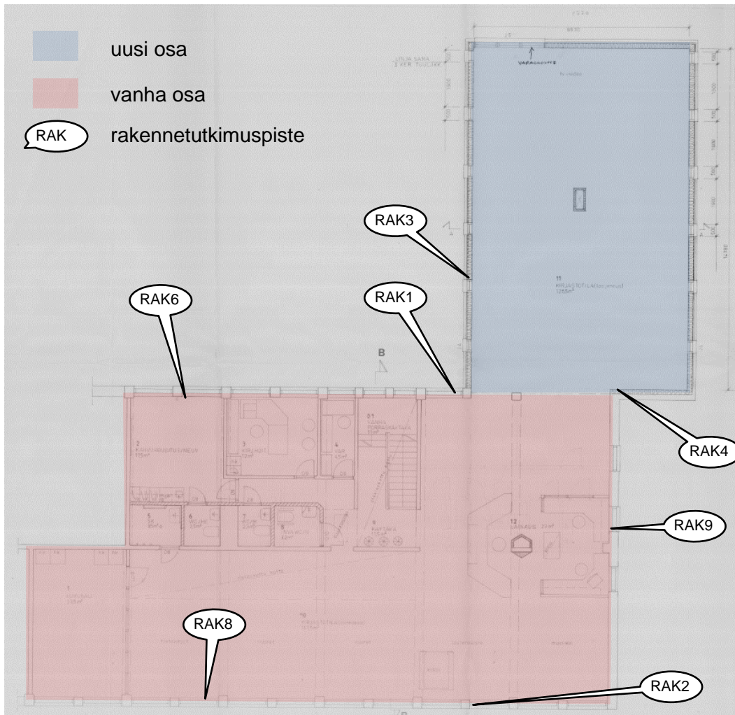
Kuva 35. Ulkoseinärakenteen tutkimuspisteiden sijainti
