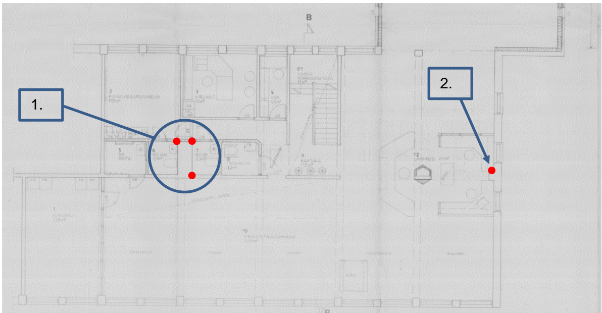
Kuva 13. Pohjakuvaan on esitetty punaisella pisteellä alueet, joissa todettiin merkkiainetta tulevan 2. -kerroksen tiloihin, kun sitä oli laskettu kellaritilaan. Pisteissä 1. kaasua havaittiin silloin, kun kaasu laskettiin kellarin vanhan viemärivuotokohdan läheisyydessä. Pisteessä 2. kaasua havaittiin silloin, kun kaasu laskettiin nuorisotilan wc-tilan kotelorakenteeseen.
