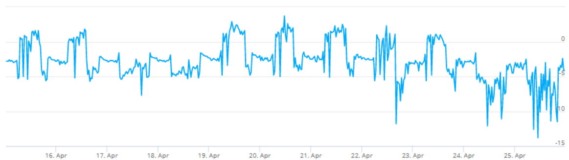
Kuva 117. Tutkimuspiste L3, Myyränmajan ryhmätila C136. Sisäilman ja ulkoilman välinen paine-ero 15.4. – 26.4.2021.
