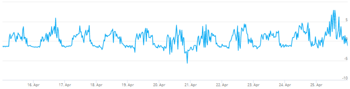
Kuva 115. Tutkimuspiste L1, Oravanpesän keittiö C152. Sisäilman ja ulkoilman välinen paine-ero 15.4. – 26.4.2021.
