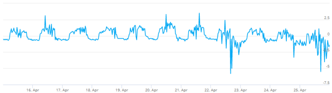
Kuva 116. Tutkimuspiste L2, Ketunkolon ryhmätila A113. Sisäilman ja ulkoilman välinen paine-ero 15.4. – 26.4.2021.
