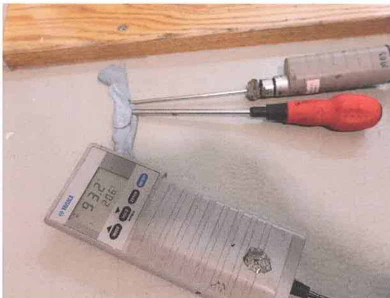
Kuva 1. Viiltomittaus tilan 128 muovimaton alta kynnyksen edustalta.
